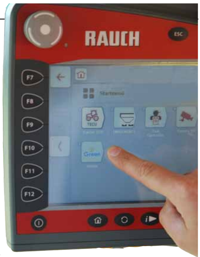
Für die Nutzung des iGreen-Netzwerkes ist lediglich ein Isobus-Terminal mit Mobilfunkanbindung erforderlich. Foto: Wobser
